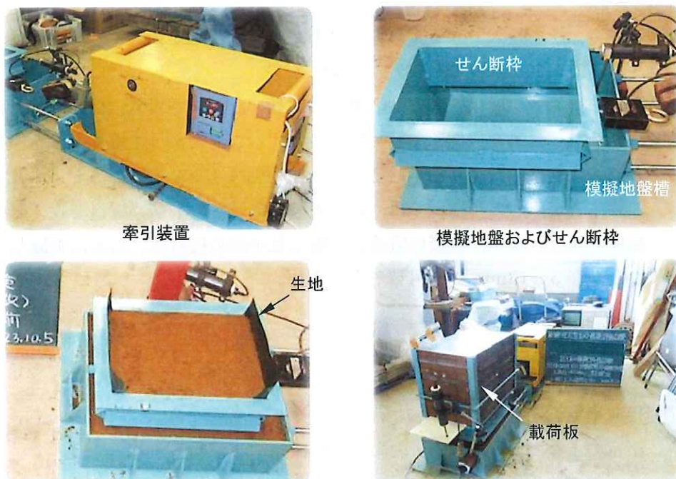
写真-3.2 摩擦試験装置および試験状況
