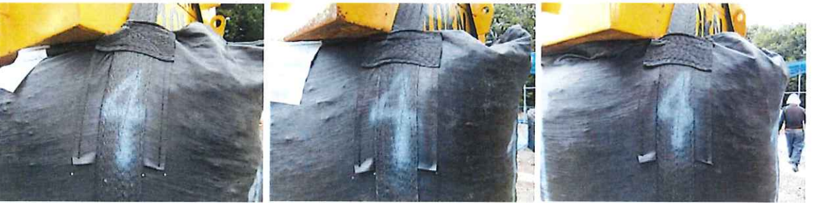
写真-4.2 吊上げ・吊下ろし評価試験後の状況(20kN 負荷時)
