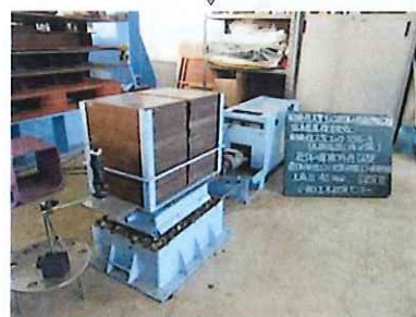
(b) 地盤と袋体との摩擦試験
