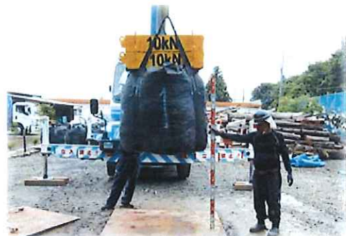
20 kN 負荷状態 (吊上げ回数;10 回目)
