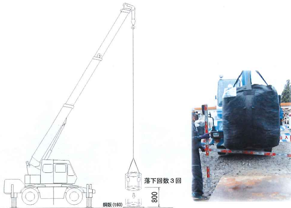
図-3.5 衝撃落下衝撃試験の概要
