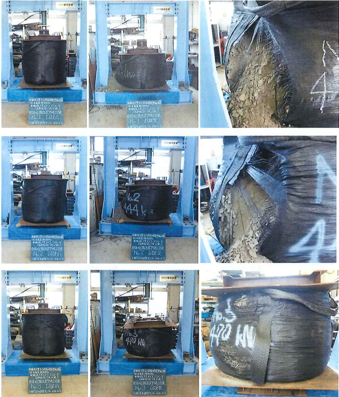
写-4.1 圧縮試験時の破壊後の袋体の状況
