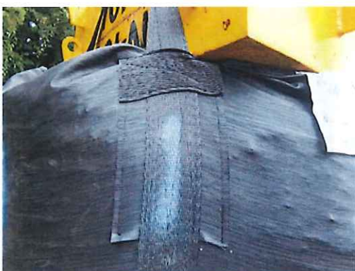
吊上げ時の本体の状況 (20kN 負荷)
