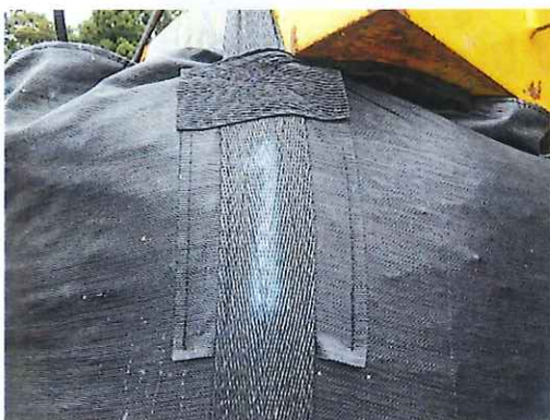
吊上げ時の本体の状況 (10kN 負荷)
