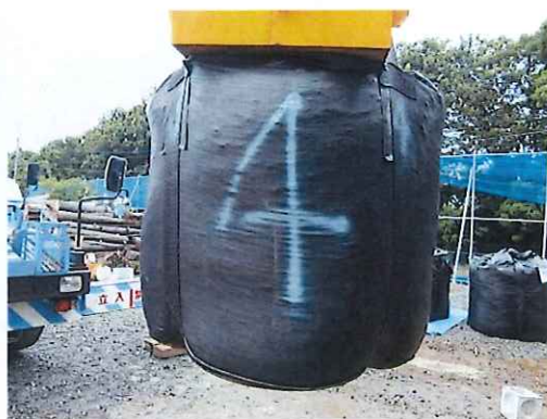
吊上げ時の本体の状況 (20kN 負荷)
