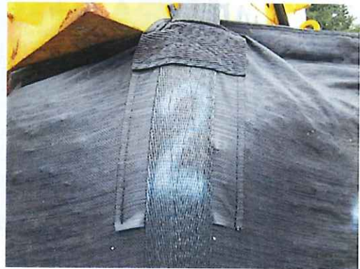
吊上げ時の本体の状況 (20kN 負荷)
