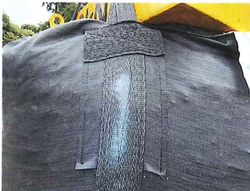
吊上げ時の本体の状況 (10kN 負荷)
