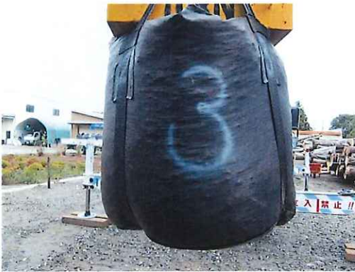
吊上げ時の本体の状況 (20kN 負荷)
