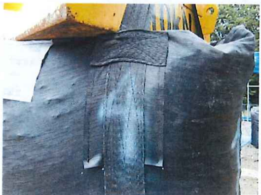
吊上げ時の吊り帯留め箇所の状況 (20kN 負荷)
