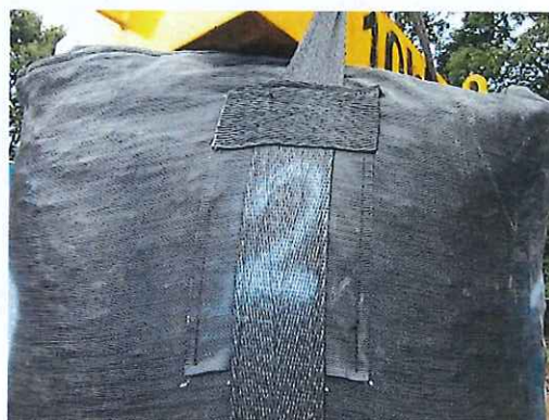
吊上げ時の本体の状況 (10kN 負荷)
