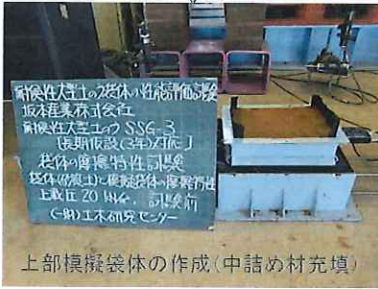
上部模擬袋体の作成(中詰め材充填)
