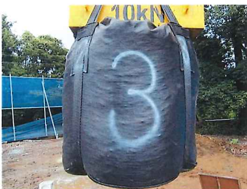
吊上げ時の本体の状況 (20kN 負荷)
