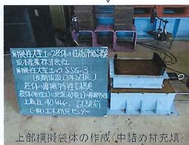
上部模擬袋体の作成(中詰め材充填)
