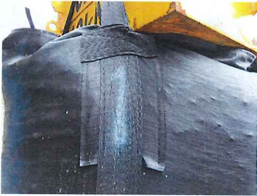
吊上げ時の本体の状況 (20kN 負荷)
