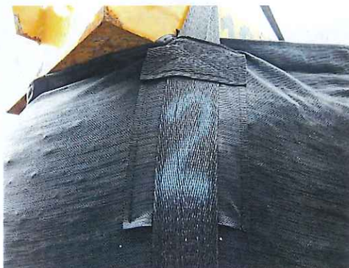
吊上げ時の本体の状況 (10kN 負荷)
