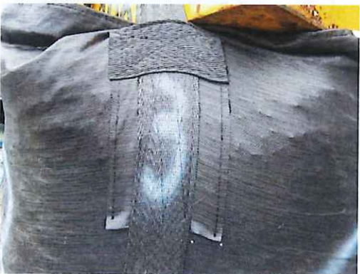
吊上げ時の吊り帯留め箇所の状況 (20kN 負荷)
