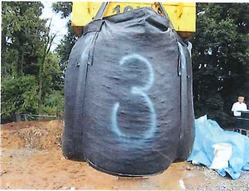
吊上げ時の本体の状況 (20kN 負荷)
